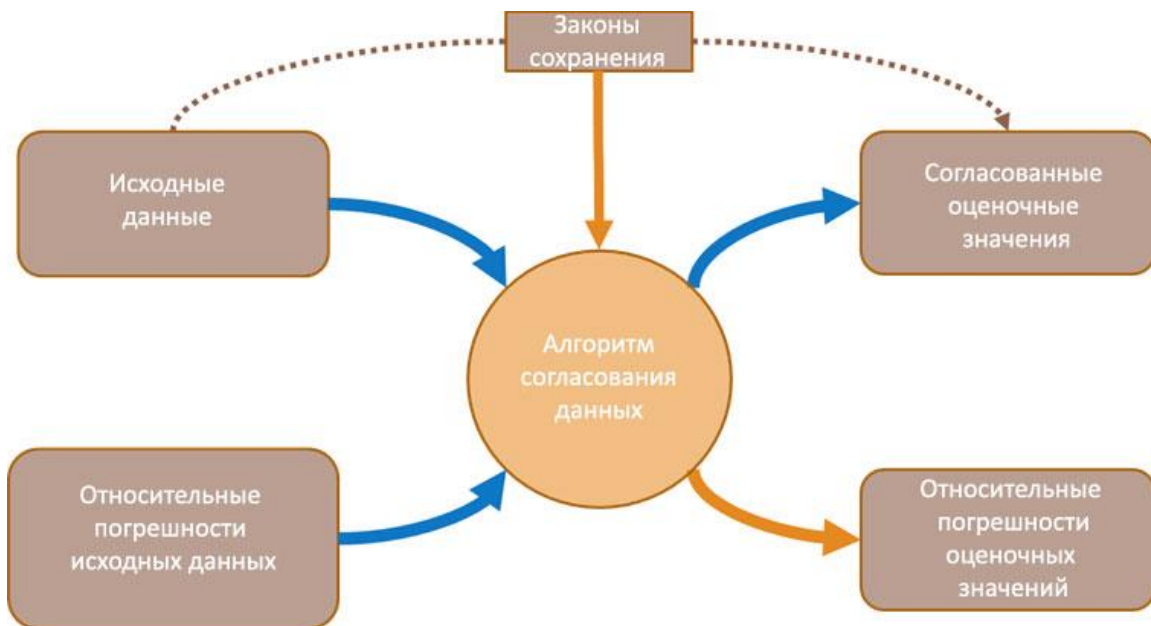
Рисунок 2. Входящие и выходящие параметры алгоритма согласования данных
