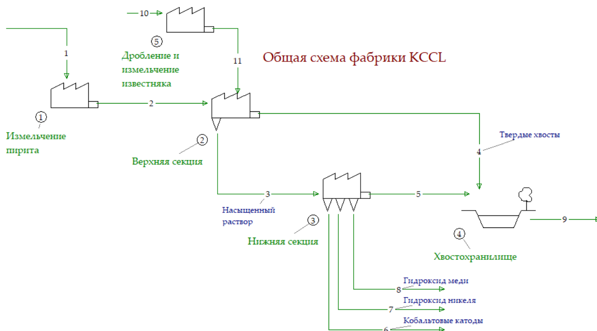
Рисунок 2. Общая схема фабрики KCCL.
